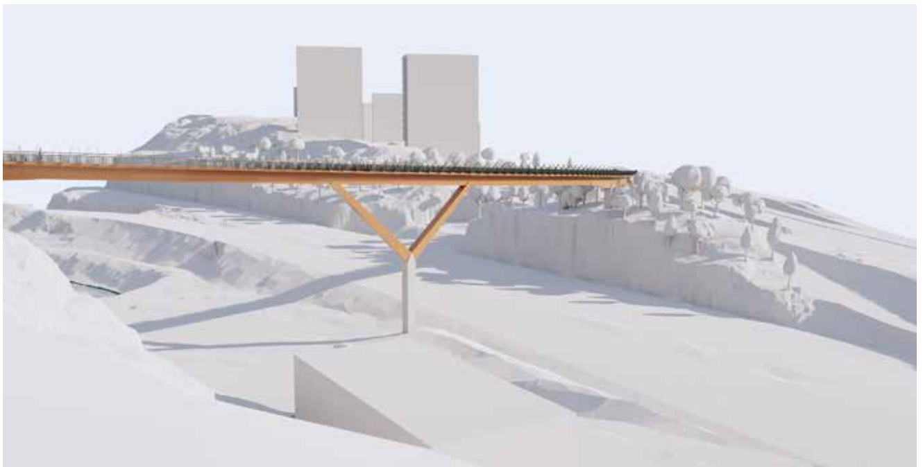
Det västra broläget sett från ett utsnitt i modellen där angöringen på Sicklasidan sker genom en brokonstruktion som går över den känsliga vegetationen och berget i dagen för att därefter landa i det befintliga GC-vägnätet. Notera att mellanstödet hamnar långt från Svindersvikens vatten. Illustration Knight Architects
